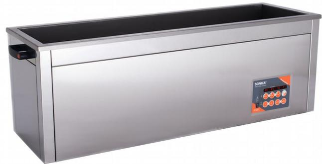
*\*Cuba especial de acero inoxidable hecha en AISI 316Ti con un espesor 20/10 con las esquinas redondeadas para una mejor eliminación de los residuos después del proceso de limpieza. La cuba está soldada con un proceso TIG.*
