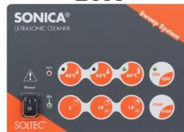
Ausführung mit elektronische Kontrolle der Reinigungszeit und der Temperatur. Die Serie ETH ist mit einem Mikroprozessor ausgestattet, der über eine wasserdichte Schalttafel die einzelnen Funktionen steuert. **Sweep System** Technologie.
