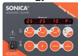
Serie EP ist die Version der Serie sehr technologisch der SONICA Version- er hat einen **Sweep Systeme** Generator; die moderne Schalttafel; Degas; eine Regelung des Temperaturs bis zu 70°C; neun unterscheiden Reinigungsprogramm; Jet Program.
