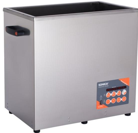
*\*Cuba especial de acero inoxidable hecha en AISI 316Ti con un espesor 20/10 con las esquinas redondeadas para una mejor eliminación de los residuos después del proceso de limpieza. La cuba está soldada con un proceso TIG*
