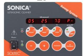
**Serie EP** è la versione con la tecnologia più avanzata della serie SONICA. Dispone di: generatore **Sweep System**; moderno pannello di comando; degas; regolazione della temperatura fino a 70°C; 9 differenti programmi di lavaggio; Jet Program.
