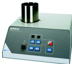
Fig. 1: bagno ad ultrasuoni SONICA per l'estrazione di particolato atmosferico
