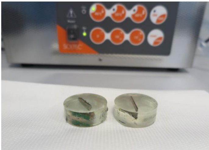
Figura 1: Due sezioni metallografiche dopo una fase di lucidatura e prima della pulizia.
