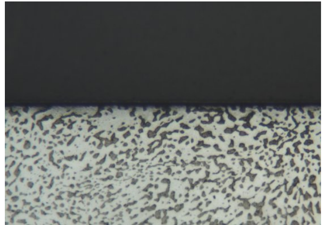
Figura 4: Esempio di una sezione metallografica sottoposta allo stesso processo di preparazione della sezione nella figura 3 con, in aggiunta, la fase di pulizia mediante ultrasuoni. Assenza di materiale estraneo.
