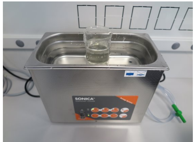
Figura 2: Immersione del campione in acqua. Utilizzo degli ultrasuoni per la rimozione dei residui di lavorazione.
